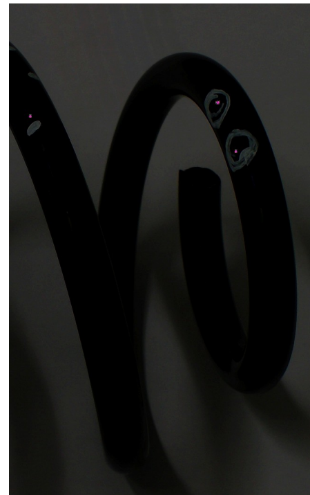
Bild 5: Korona-Entladungen an den Poren
