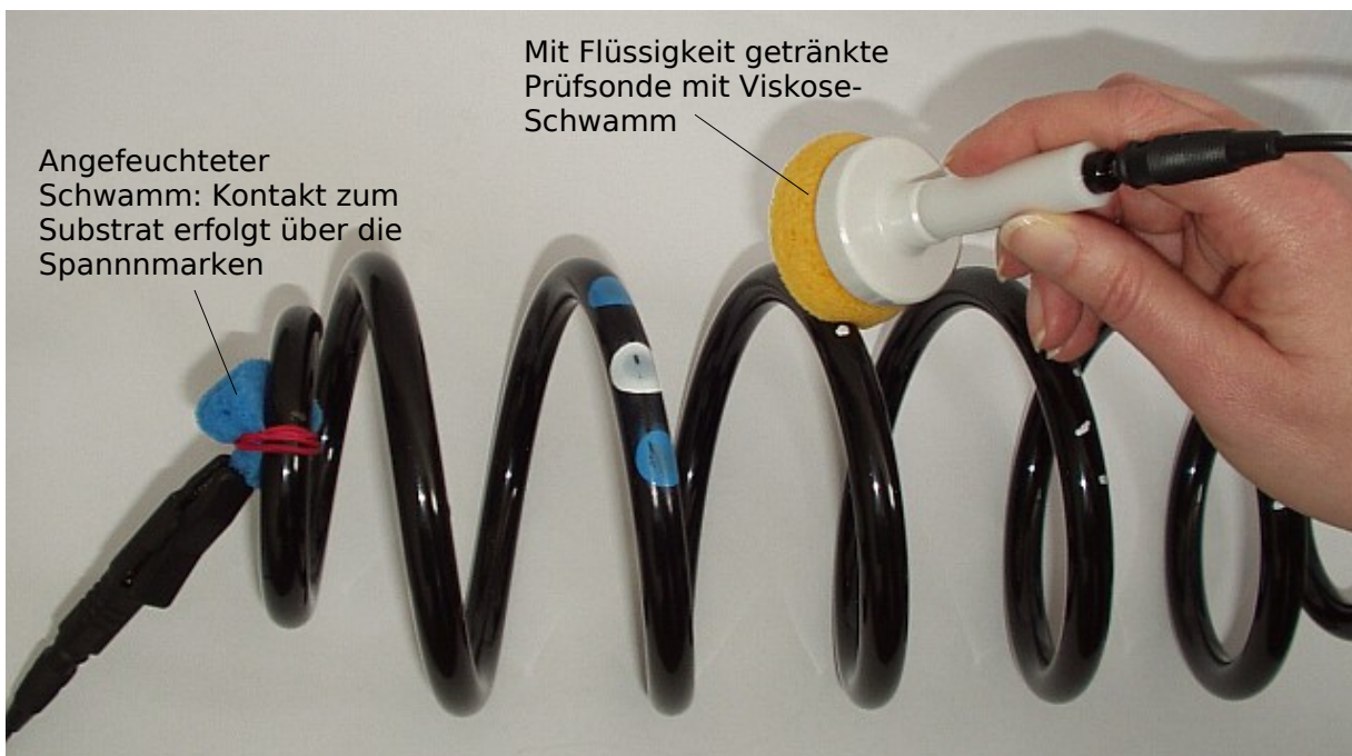
Bild 1: Bei der Achsfeder wurde der Kontakt zum leitfähigen Substrat indirekt über einen angefeuchteten Schwamm hergestellt, an den das Anschlusskabel mit Krokodilklemme befestigt wurde. Der feuchte Schwamm wurde an einer der Spannmatten, die sich an einem Ende der Achsfeder befinden platziert.
