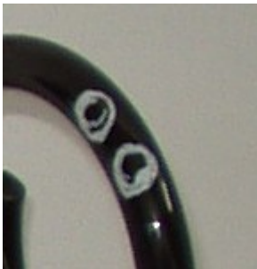
Bild 3: Markierungen auf Achsfeder
